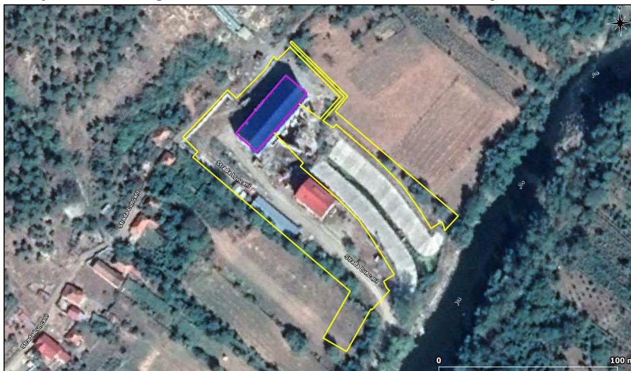
Fig. 37 Încadrarea în teritoriu a clădirii CHE Bumbști (poligon de culoare mov) și a suprafețelor vizate de realizarea amenajării exterioare, platforme, împrejuriri și rigole (poligoane de culoare galbenă)
